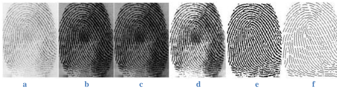
Figura 3 – a - imagem obtida do leitor biométrico; b – imagem equalizada; c – imagem sob ação do filtro gaussiano; d – imagem sob ação do filtro motion blur ; e – imagem binarizada com threshold adaptativo; f – imagem afinada com um pixel de largura.
